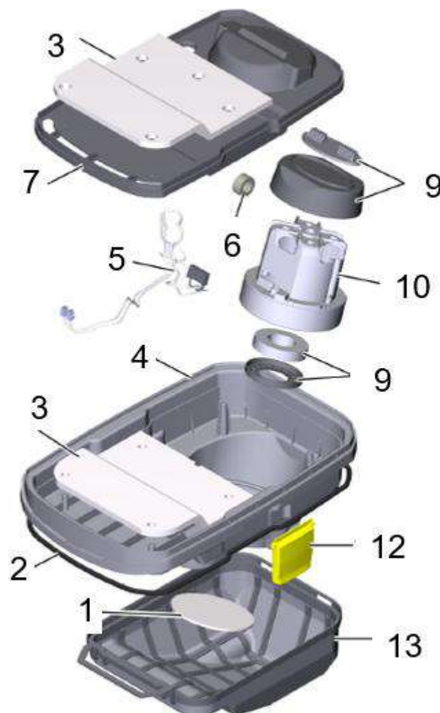
Figure 2 : Vue éclatée de la turbine d'aspiration
