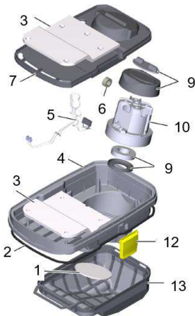
Fig. 2: Vista esplosa della turbina d'aspirazione
