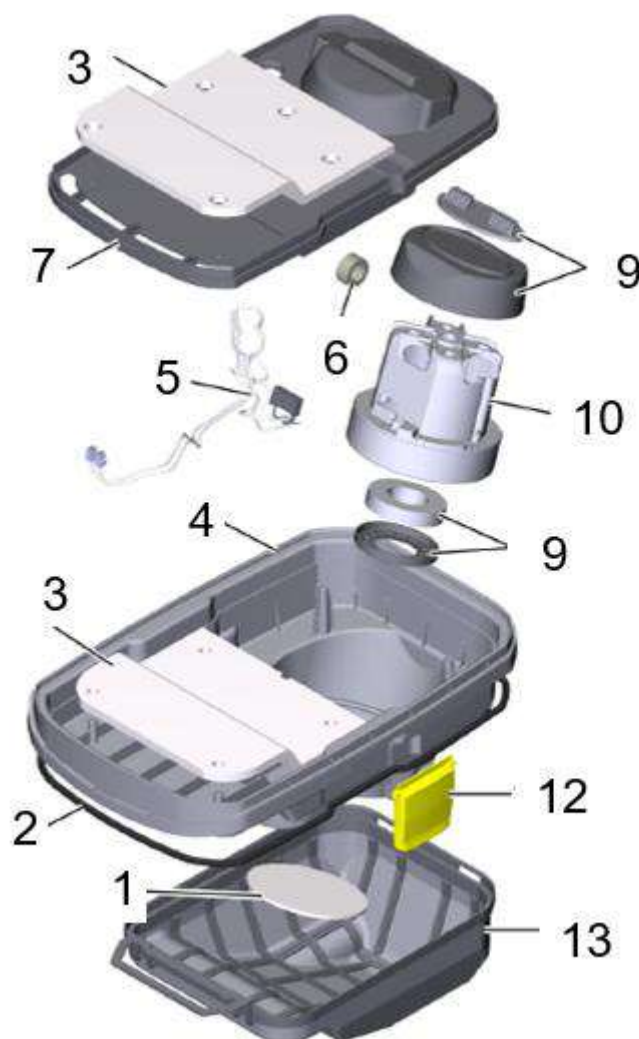
Abbildung 2: Explosionsansicht der Saugturbine
