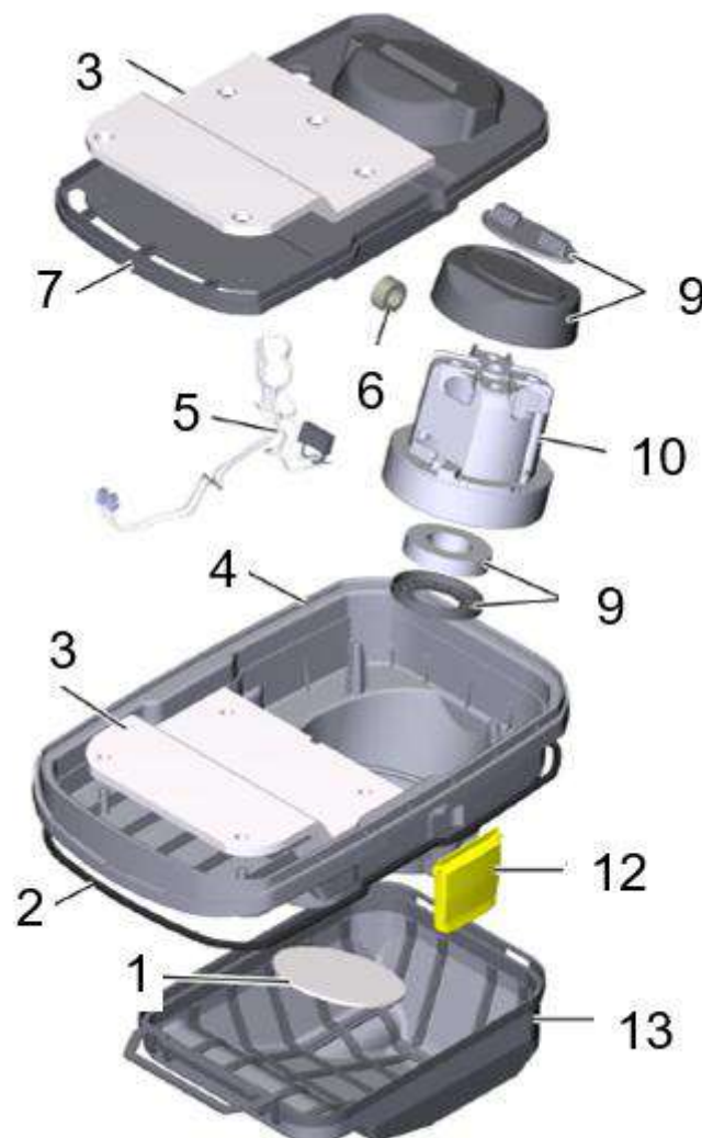
Ilustración 2: Vista desarrollada de la turbina aspiradora
