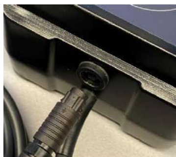
Fig.6 Weiße Punkte aufeinander ausrichten und Stecker in die Buchse schieben
