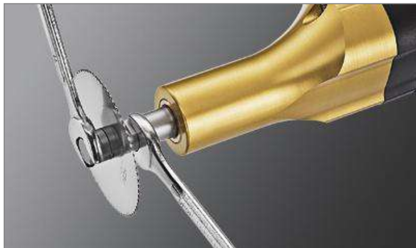
Ilustración 1: Soltado del tornillo de sujeción
