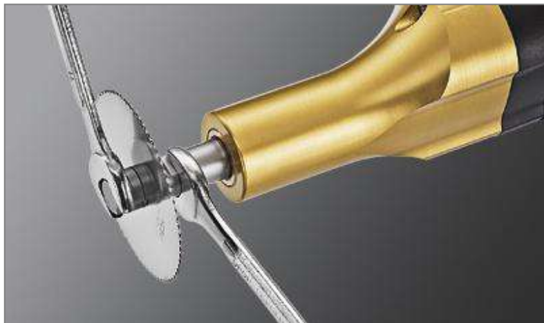
Abbildung 1: Lösen der Halteschraube
