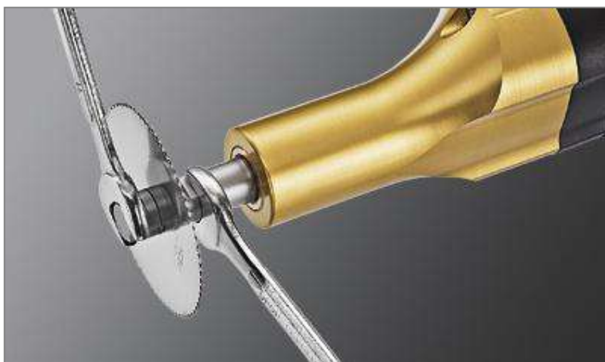
Fig. 1: Desserrer la vis de maintien
