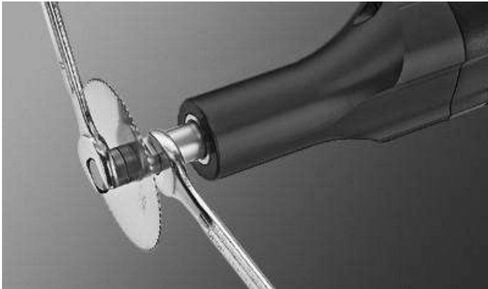
Ilustración 1: Soltado del tornillo de sujeción
