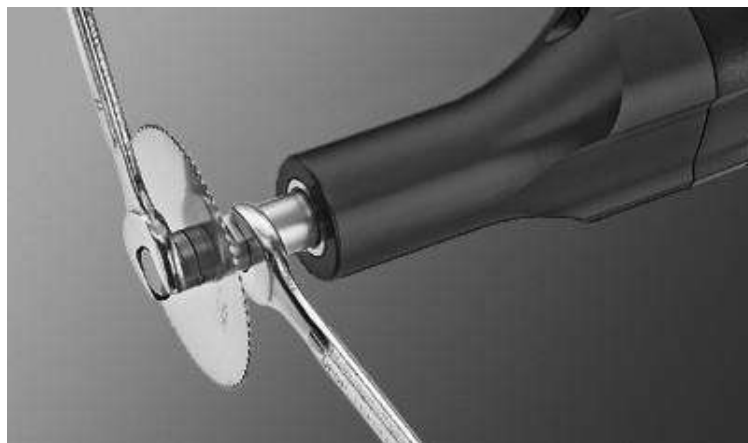
Abbildung 1: Lösen der Halteschraube
