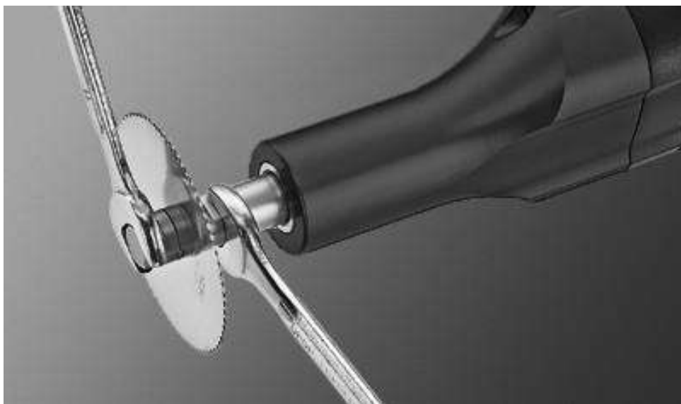
Figura 1: Svitare la vite di fissaggio
