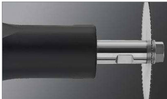
Ilustración 2: Colocación de la hoja de la sierra
