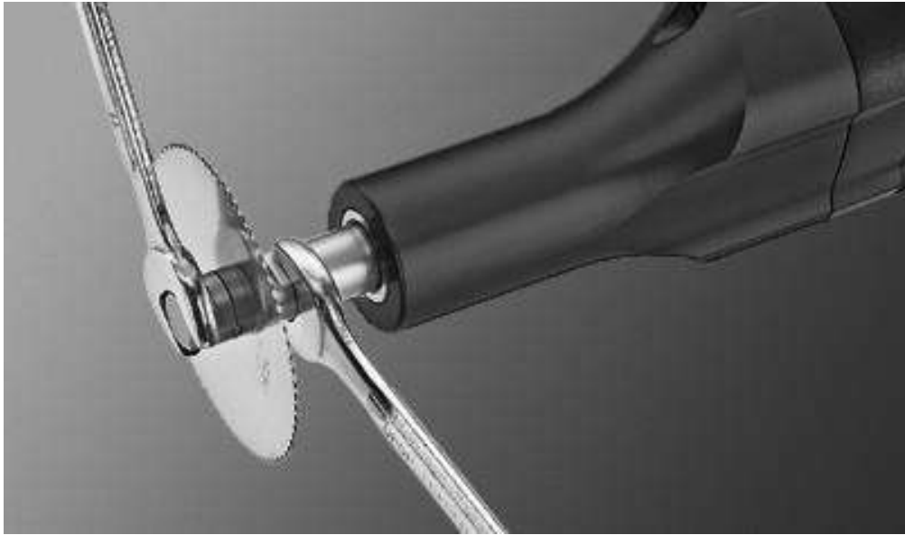
Fig. 1: Desserrer la vis de maintien
