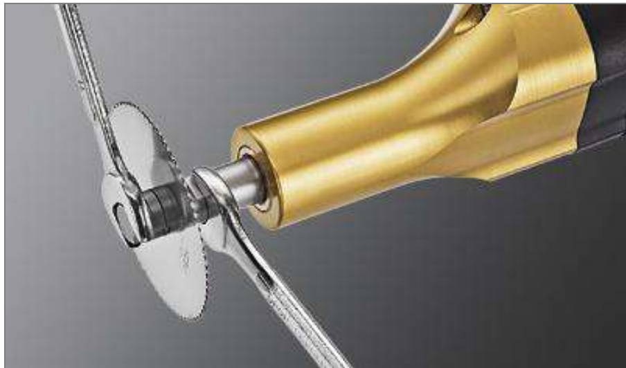
ilustración 3 Soltado del tornillo de sujeción
