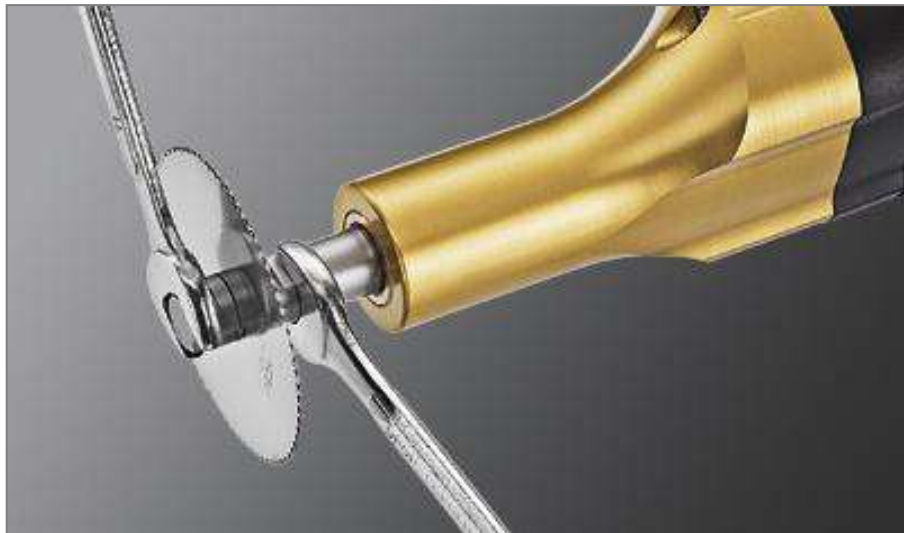
Abbildung 3 Lösen der Halteschraube
