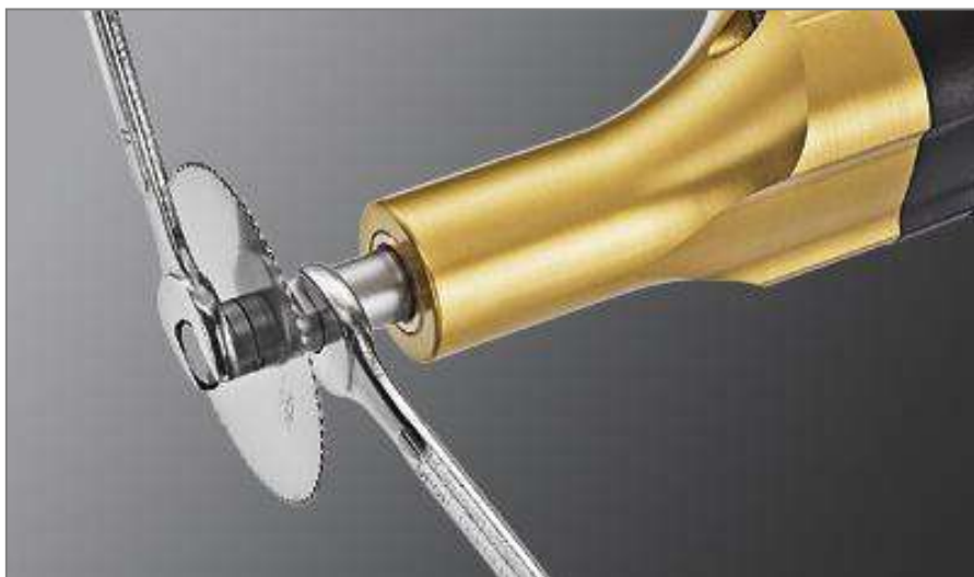
figure 3 Desserrer la vis de maintien
