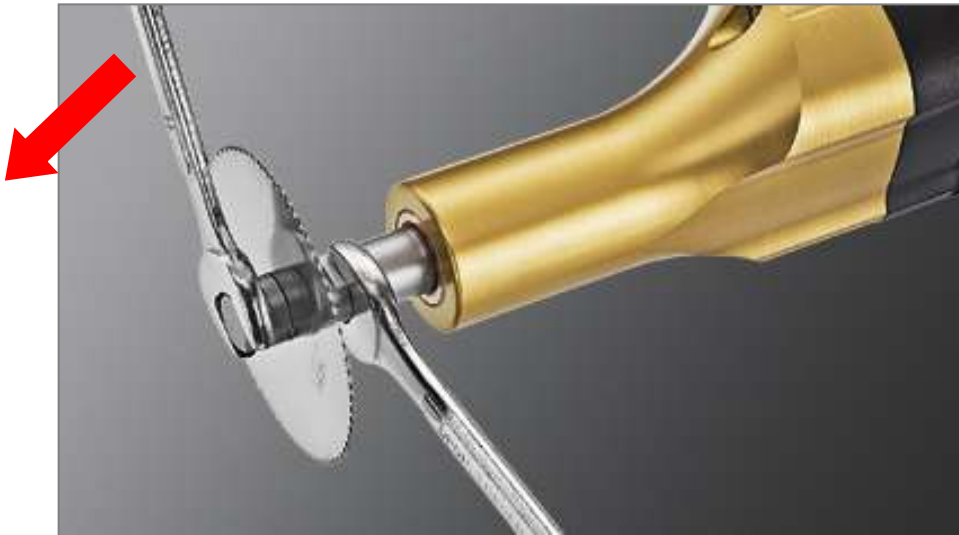
figura 3 Svitare la vite di fissaggio
