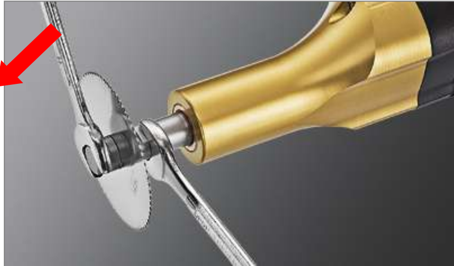
ilustración 3 Soltado del tornillo de sujeción
