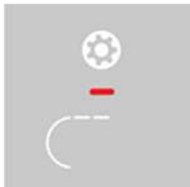
Abbildung 1: Störungsbeispiel der Bedieneinheit mit 3 aufleuchtenden Elementen → Störung/Ausfall Kombisensor CO2
