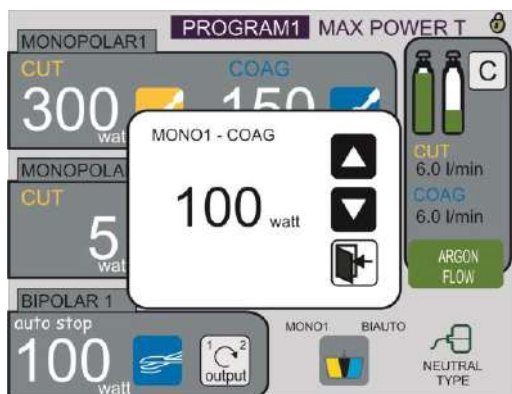
Exemple de menu: Réglage de la puissance (MONO1- COAG)
