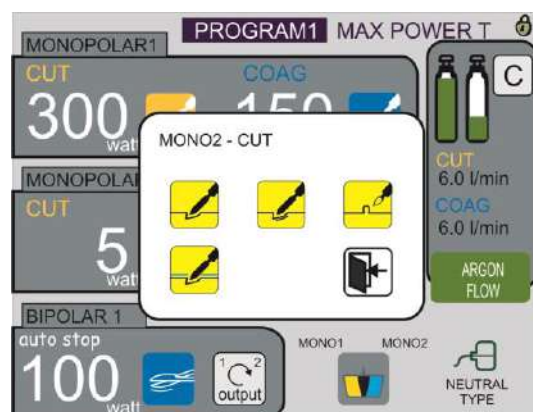
Exemple de menu: Sélection des modes de fonctionnement (MONO – CUT)
