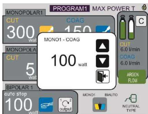
Ejemplo del menú: Ajuste de la potencia (MONO1- COAG)
